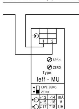
Bei Geräten mit Frequenzmodul entfallen weitere Ausgänge. An den Klemmen +13 und -14 steht der Frequenzausgang zur Verfügung.
