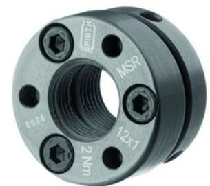
Für die zulässige statische Axiallast wird die Streckgrenze des Materials mit einer Nutzsicherheit von 1,6 herangezogen. Sie gilt für ein Wellengewinde mit der Toleranz 6g oder genauer sowie mit einer Mindestfestigkeit von 700 N/mm<sup>2</sup>. Bei dynamischer Belastung sind ca. 75% der statischen Axiallast  $F_{ax,stat}$  zulässig.
