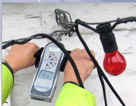
Zugtest an Verankerungspunkten
