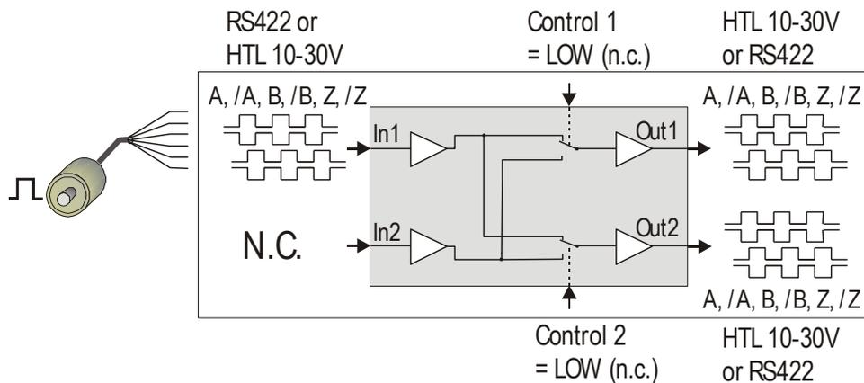
L'encoder è collegato all'ingresso 1, mentre l'ingresso 2 rimane non collegato. L'ingresso può essere impostato al livello simmetrico (differenziale) con utilizzo dei canali A, /A, B, /B, 0, /0 o al formato asimmetrico (single-ended) con utilizzo dei soli canali A, B, 0.
