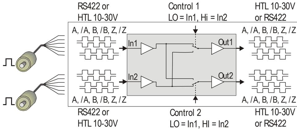
Entrambi gli ingressi possono essere impostati singolarmente al formato simmetrico (differenziale) con utilizzo dei canali A, /A, B, /B, 0, /0 oppure al formato asimmetrico (single-ended) con utilizzo dei soli canali A, B, 0.
